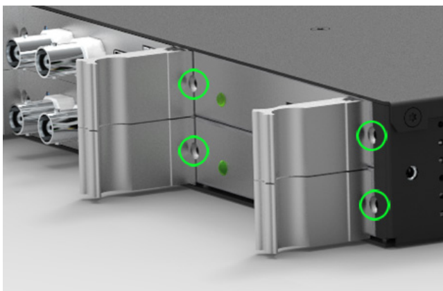
Befestigungspunkte bei einem 1HE IMS System
