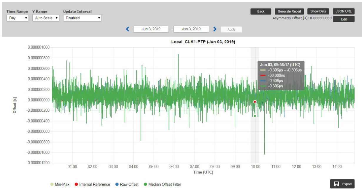
Abbildung: Grafische Darstellung der Offsetwerte für jeden Knoten, wählbar für verschiedene Zeitbereiche (Tag, Woche, Monat oder manuelle Auswahl). Mit vorgegebenen Schaltflächen im „Zeitbereich auswählen“ können Sie für die grafische Darstellung entweder vergangene oder zukünftige Intervalle auswählen.
